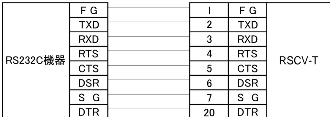
4) パソコン等とRS232Cで接続するときに、ストレートケーブルを用いる端末機器の場合
