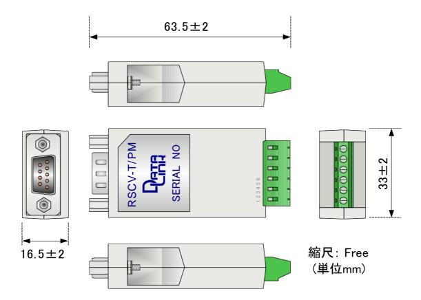
◆ RS232Cコネクタ: Dsub9Pオ ス取付ネ ジ:#4-40 UNC インチネジ
