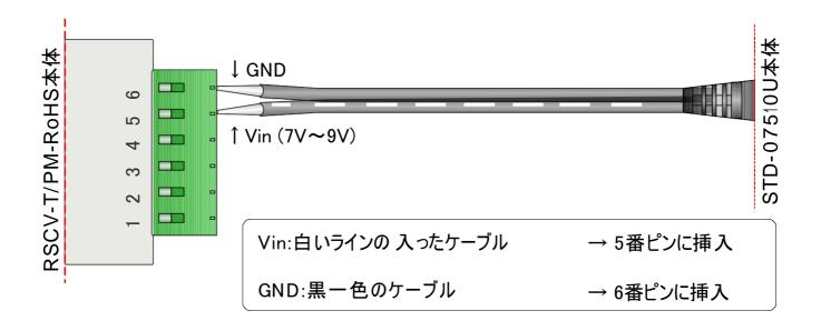
RS422に使用するケーブルは、端子台の挿入口の大きさにより、以下のものに指定されています。
