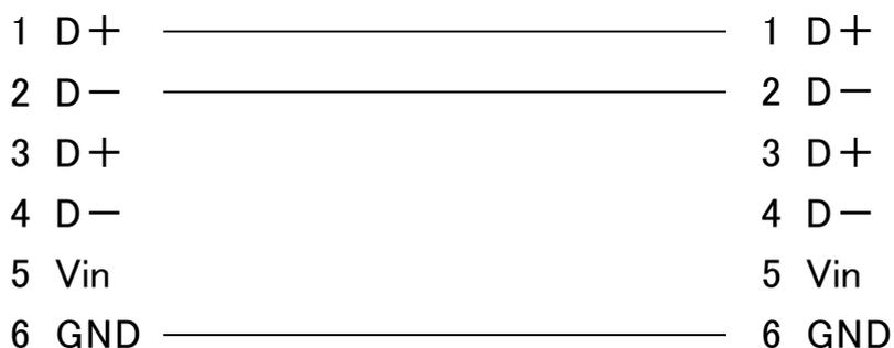
実際の使用環境によっては、RS485ネットワークのデータ線[D+] [D-] 間に端子台にて終端抵抗を追加する必要があります。
