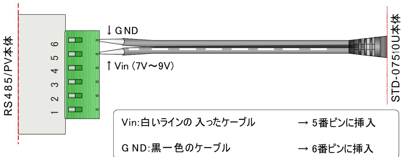
RS485に使用するケーブルは、端子台の挿入口の大きさにより、以下のものに指定されています。また、弊社で通信テストに使用したものを下記に示しましたので、ご参考ください。
