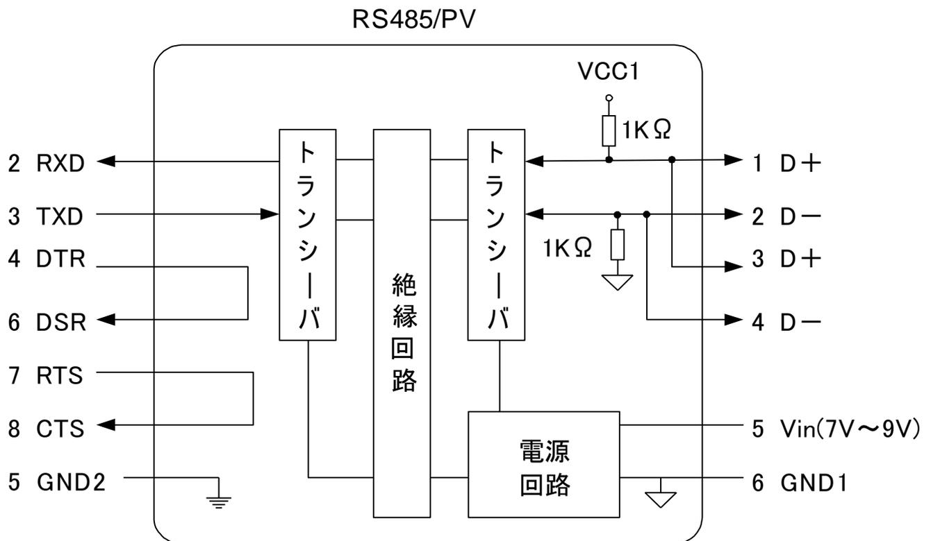
※ 上図の[1ピンD+と3ピンD+]、[2ピンD-と4ピンD-]は内部でショートしています。従って、バス接続のように1つのピンに2本の結線を行う場合で、接続が難しいときは下図点線のような接続が可能です。
