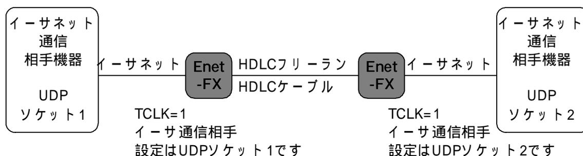
Enet-FXの HDLC 側設定は、同じ設定とします。同期クロックの設定には注意が必要です。上図では双方 TCLK=1としています。
