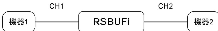
チャンネル1のフロー制御設定ディップスイッチをXON/XOFF、チャンネル2のフロー制御設定ディップスイッチをRTS/CTSに設定します。
