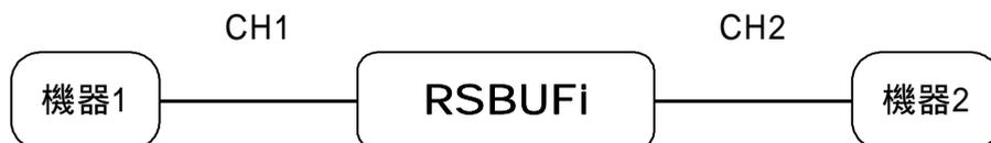
チャンネル1の通信速度設定ディップスイッチを9600bps、チャンネル2の通信速度設定ディップスイッチを1200bpsに設定します。
