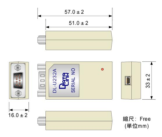
RS232C コネクタ: Dsub9ピンオス 取付ネジ: #4-40 メスネジ
